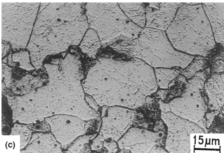
Figura 6 - Microestrutura do aço 2,25Cr-1Mo, aquecido na faixa da austenita e resfriado com diferentes taxas, observada utilizando microscopia óptica. (a) Estrutura completamente martensítica. (b) Estrutura bainítica. (c) Estrutura mista de ferrita pro-eutetóide e bainita. (Adaptado de [6])
