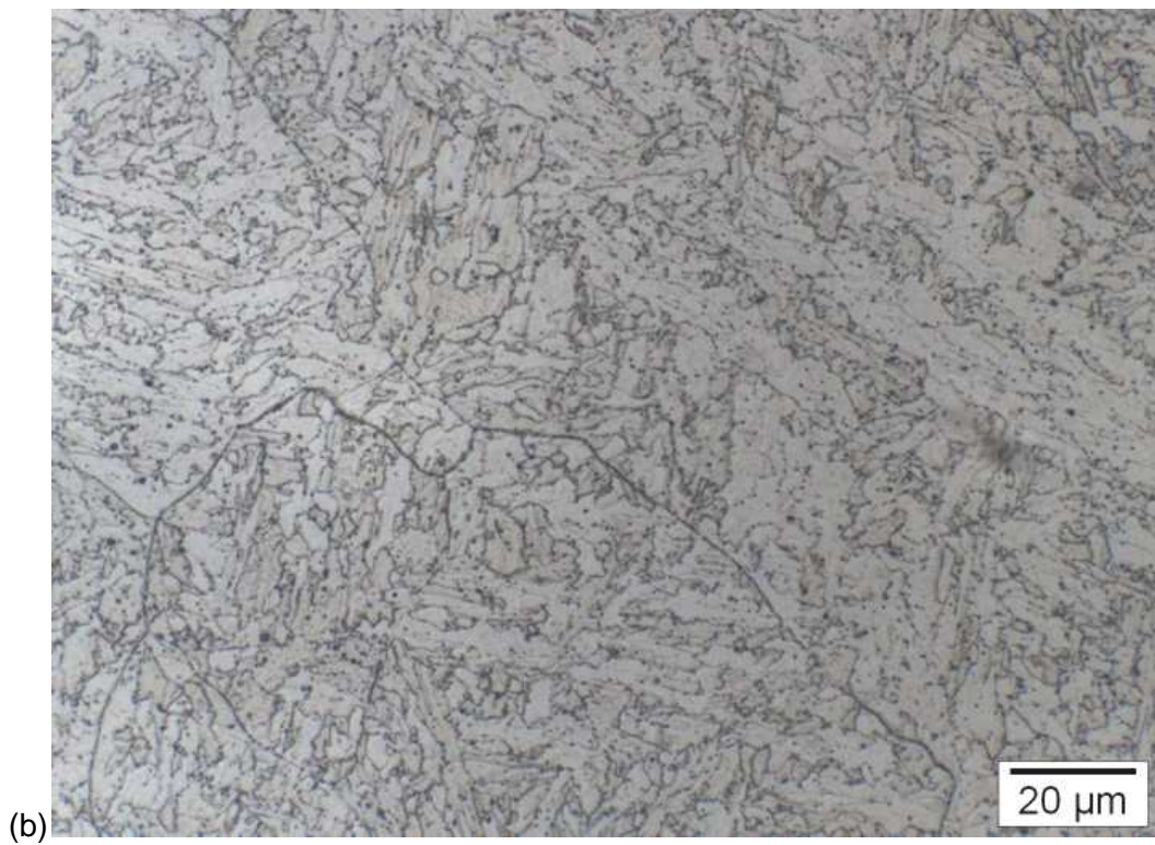
Figura 33 – Microestrutura do metal de solda analisada com o microscópio óptico. Aumentos nominais de (a) 500x e (b) 1000x.
