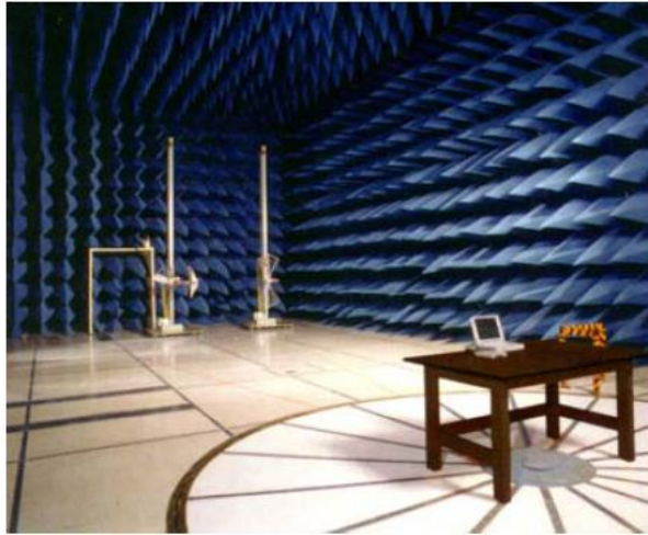
Figura 1.1 - Foto real com ambiente de testes de emissões radiadas.
