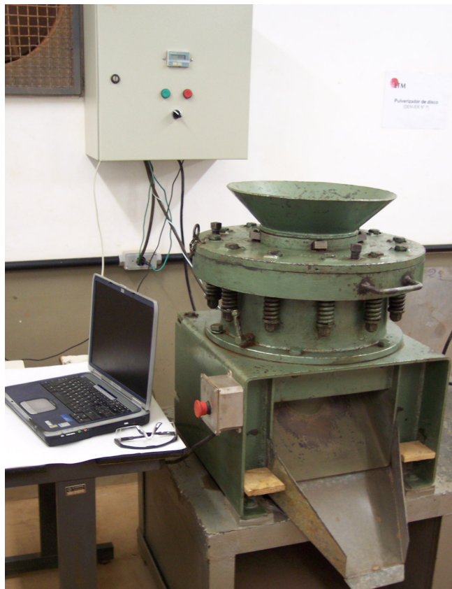
Figura 4.1: Britador Cônico Denver nº 12 do laboratório LTM equipado com medidor de potência (Tavares e Silveira, 2008).
