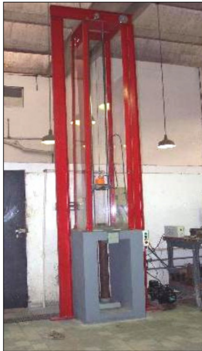
Figura 4.2: Célula de Carga de Impacto de 100 mm do LTM (Silveira, 2009)
