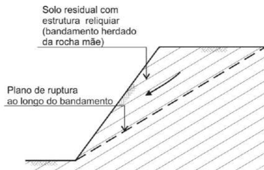
Figura V.23 - Ruptura planar em solo residual de gnaiss com anisotropia de resistência devido ao bandamento da rocha mãe (Geo-Rio, 2014).
