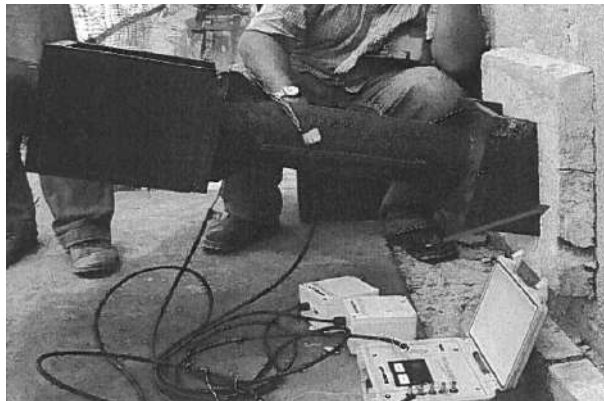
Figura VI.22 – Esquema para leitura das células de carga instaladas nos tirantes.
