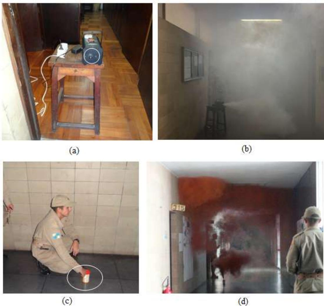
Figura 3.10: Fumaça artificial utilizada na simulação: (a) *FOG machine*; (b) Fumaça gerada através da *FOG*; (c) fumígeno; (d) fumaça gerada pelo fumígeno.
