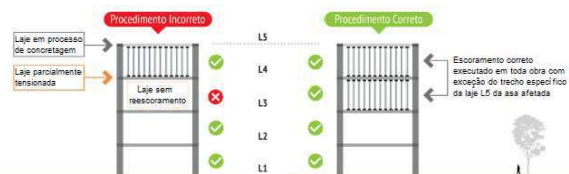
Figura 5.16 – Procedimentos incorreto e correto de concretagem do Shopping Rio Poty (FREITAS, 2013)
