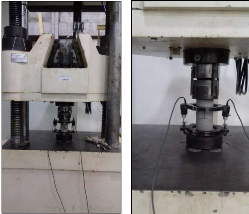
Figura 3.7 - Ensaio de resistência à compressão em corpo-de-prova cilíndrico 7,5x15 cm.
