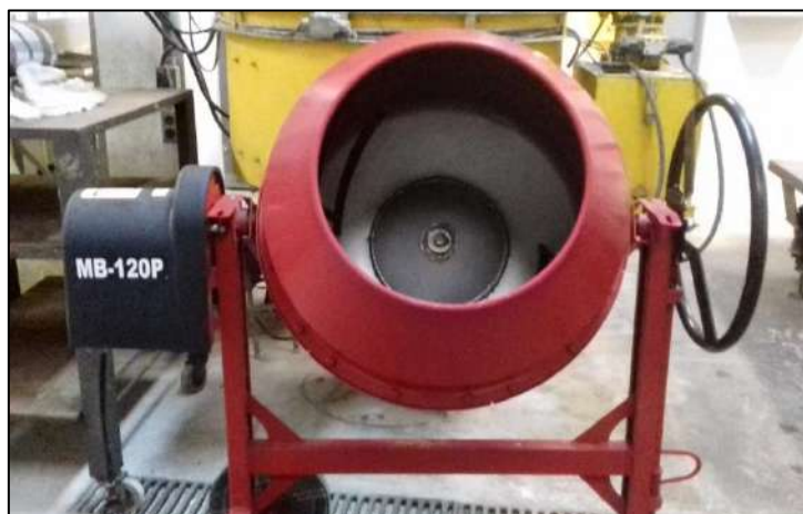
Figura 4.1 - Misturador utilizado na produção dos concretos.
