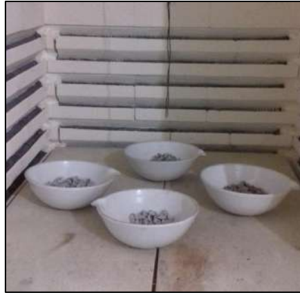
Figura 3.3 - Amostra dos agregados dentro do forno para o aquecimento.
