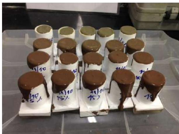
Figura 3.11: Moldagem dos corpos-de-prova das pastas de referência e com 5,10 e 15% de substituição do cimento por IOT.
