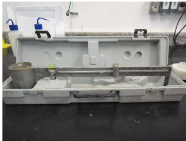
Figura 3.18: Balança de Lama utilizada na determinação da massa específica aparente.
