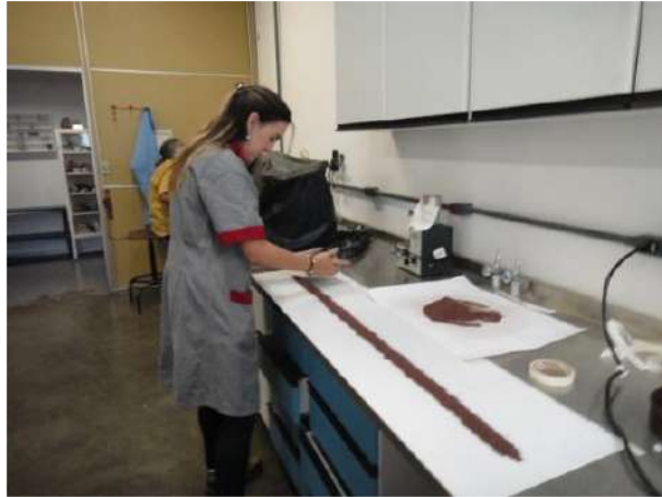
Figura 3.8: Formação da pilha para realizar o quartejamento do rejeito de minério de ferro.
