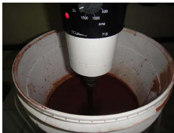
Figura 3.4: Homogeneização da lama de rejeito com auxílio do agitador mecânico Fisatom modelo715.
