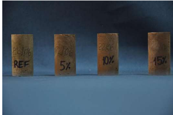
Figura 3.12: Corpos-de-prova desmoldados das pastas de referência e com 5,10 e 15% de substituição do cimento por IOT.
