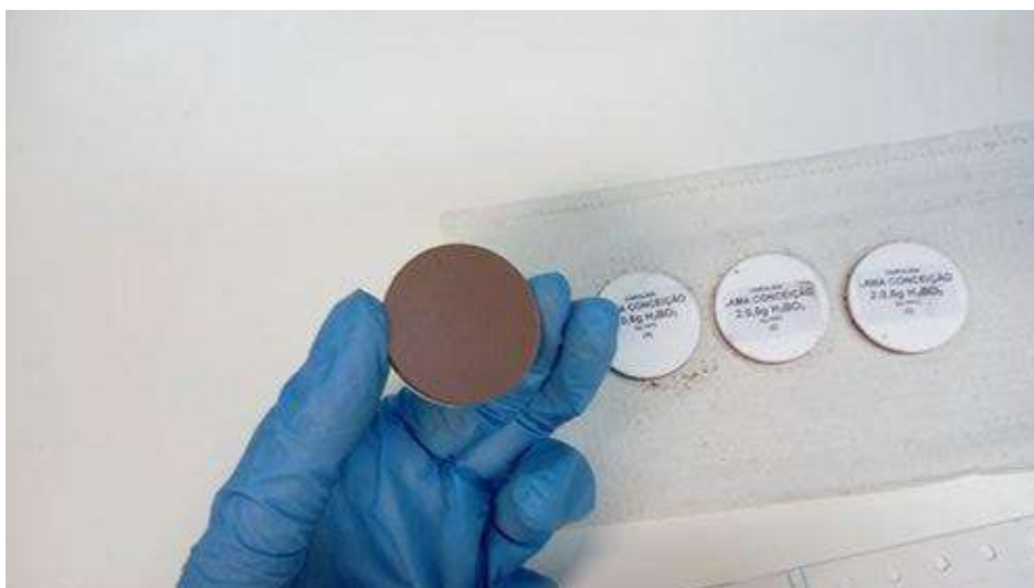
Figura 3.10: Amostra de rejeito prensada com aglomerante ácido bórico ( H_3BO_3 ).
