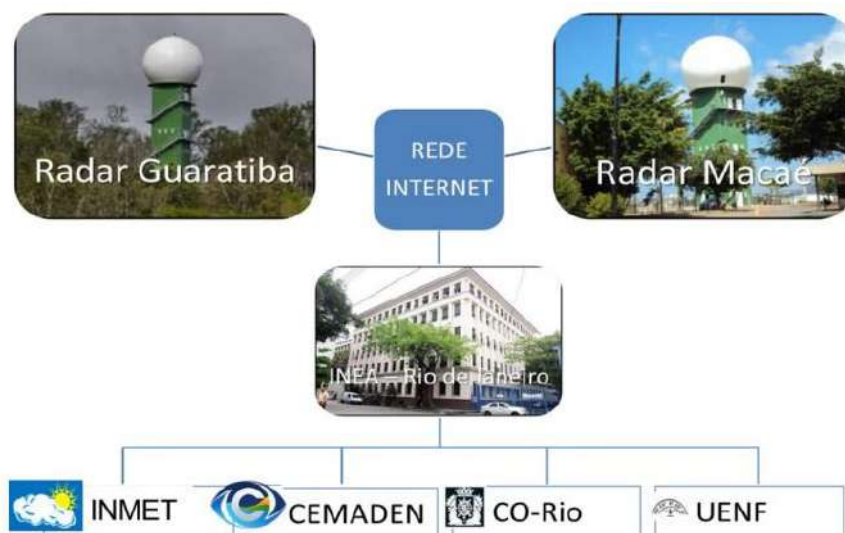
Figura 124 - Rede do Sistema de Alerta de Cheias do Estado do Rio de Janeiro Fonte: Protocolo Operacional do Sistema de Alerta de Cheias do INEA
