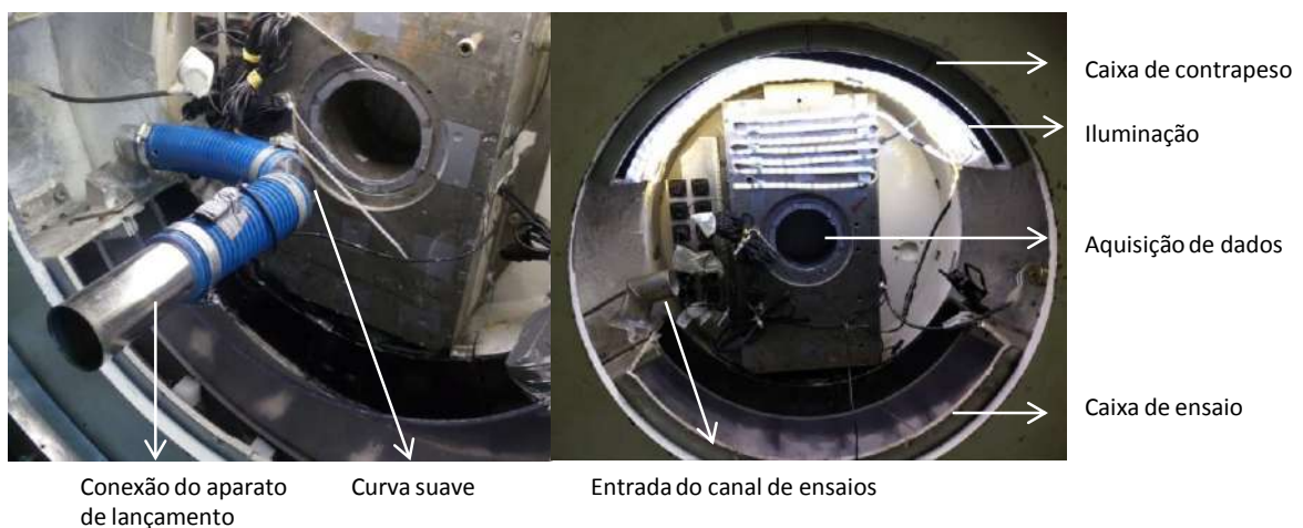
Figura 3.9 –Visão geral da montagem do aparato experimental
