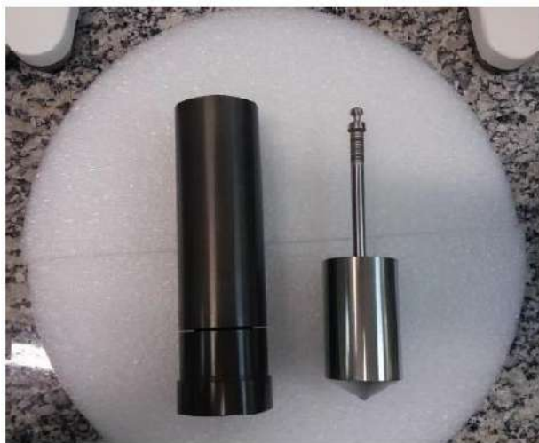
Figura 2 - Geometria de cilindros concêntricos
