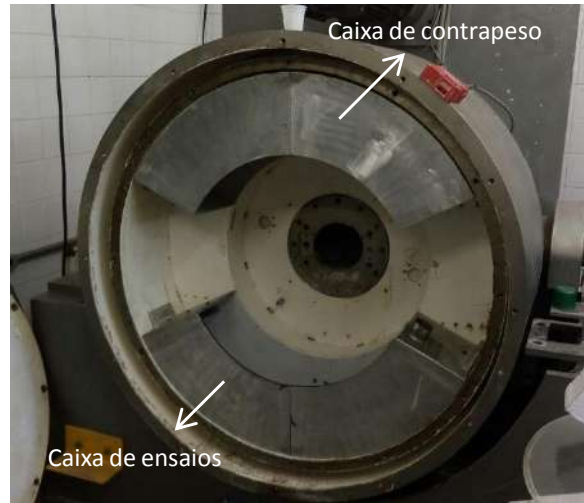
Figura 3.5 – Caixa de ensaios e caixa de contrapeso
