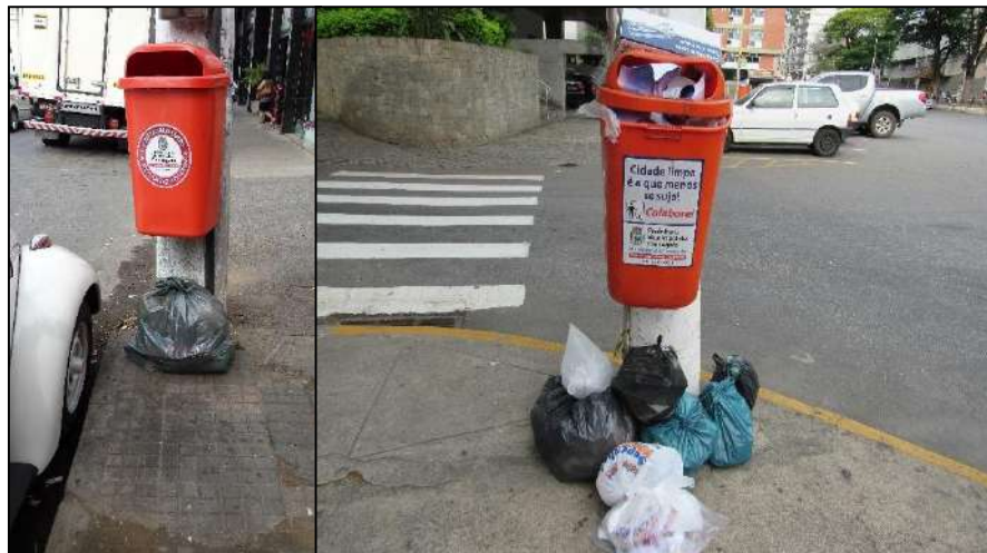
Figura 34: Coletores com capacidade inferior a necessária, gerando problemas no armazenamento do lixo público Fonte: pesquisa de campo - 27/10/2016
