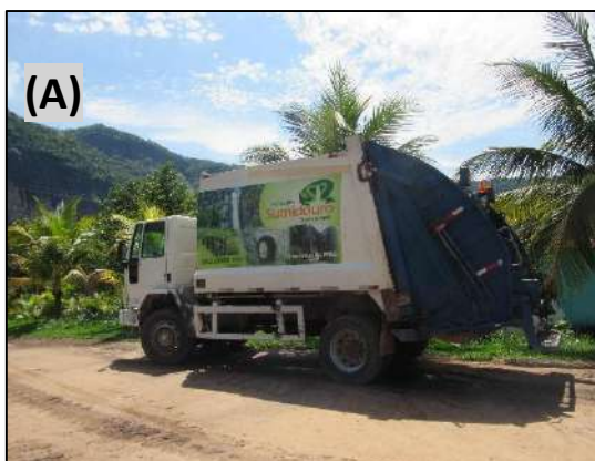
Figura 72: Veículos usados na coleta de resíduos de Sumidouro. (A) Caminhão do Tipo Compactador para coleta convencional; (B) Caminhão aberto do tipo “basculante” para coleta seletiva a ser implantada Fonte: pesquisa de campo - 17/11/2016
