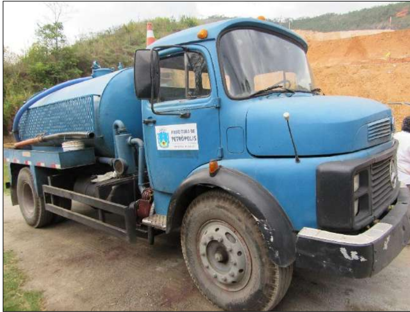
Figura 47: Aterro Sanitário de Pedro do Rio – caminhão de transporte de chorume para tratamento combinado em ETE – Estação de Tratamento de Esgoto. Fonte: pesquisa de campo – 03/11/2016
