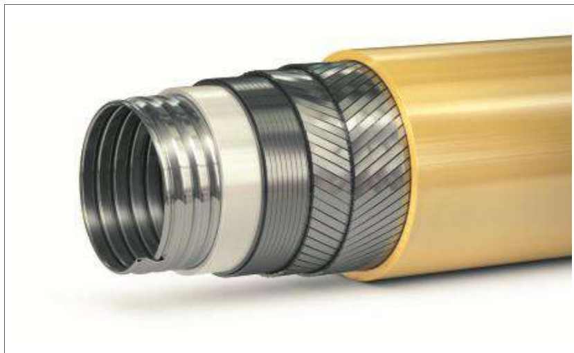
Figura I.1 –Estrutura típica de riser flexível composto por várias camadas metálicas helicoidais e camadas poliméricas.
