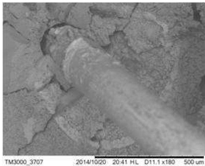
Figura 4.144: Densificação da interface fibra-matriz após 3 meses de ciclos de molhagem e secagem resultando na formação de várias fissuras
