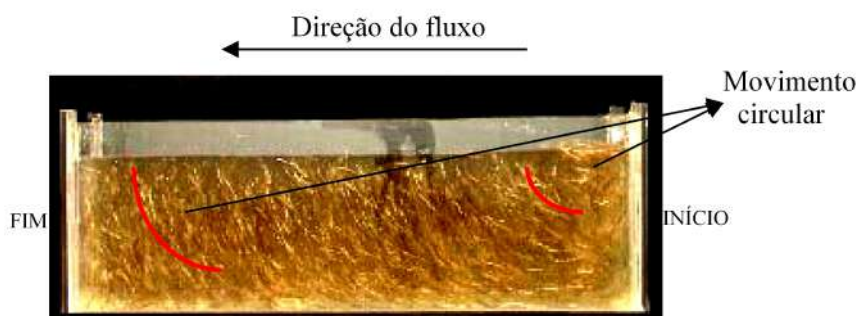
Figura 4.16: Orientação das fibras de aço (0.5%) em matriz transparente (Adaptado de Van Mier et al , 2012)
