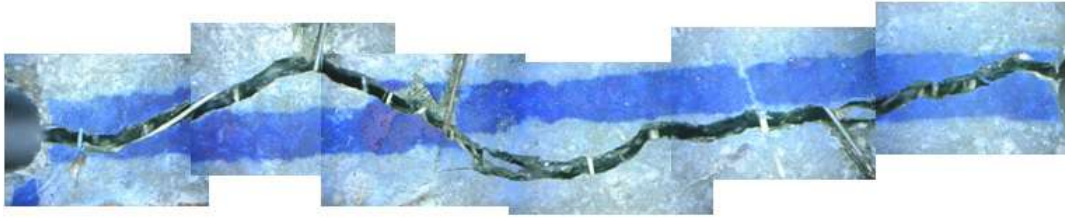
Figura 4.55: Formação da fissura da amostra A34
