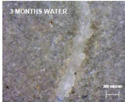
Figura 2.7: Precipitação de Carbonato de Cálcio na fissura. (KRELANI, 2015)
