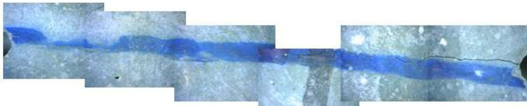
Figura 4.38: Formação da fissura da amostra C24
