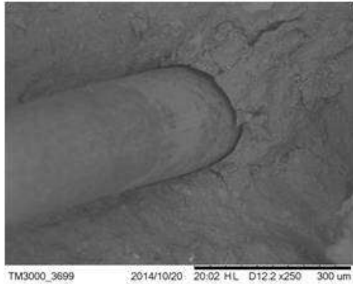
Figura 4.143: Interface fibra-matriz mostrando o deslizamento da fibra de aço na matriz aos 28 dias
