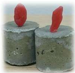
Figura 3.13: Corpo de prova de arrancamento com fibra protegida por cera
