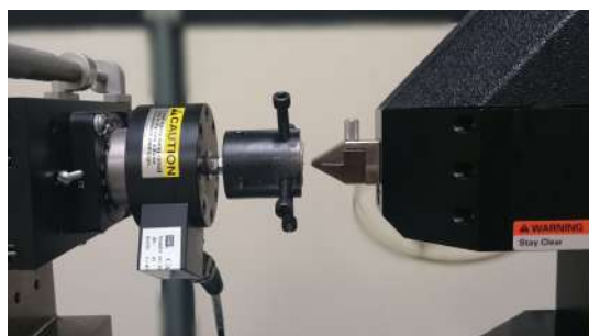
Figura 3.14: Ensaio final de arrancamento, em andamento, após 2 meses de ciclos de molhagem e secagem
