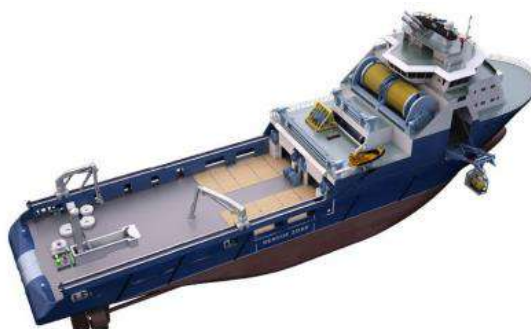
Figura 2.26 Supridor, rebocador e manuseio de âncoras (SILVEIRA, 2013)
