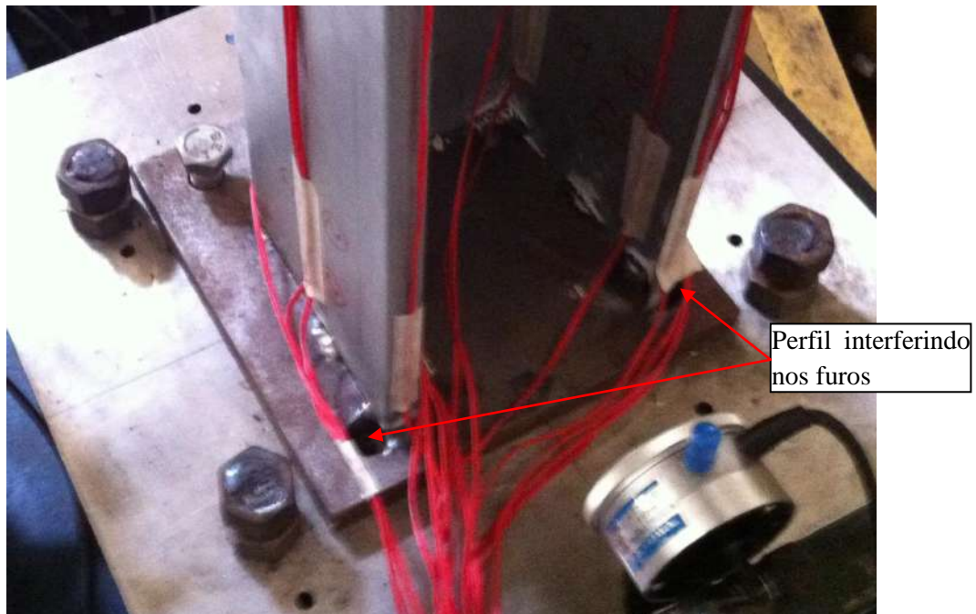
Figura 6.9: Furos sobrepostos pelo perfil.
