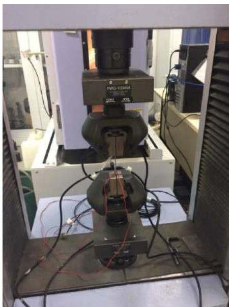
Figura 6.25: Configuração do ensaio de tração direta.
