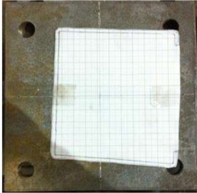
Figura 6.8: Posicionamento do papel milimetrado na chapa de extremidade.
