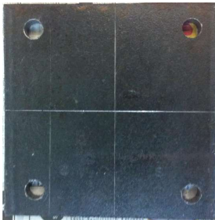
Figura 6.7: Chapa de extremidade com eixos marcados (riscados).
