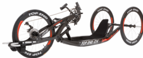
Figura 18 - Modelo de triciclo delta. Esse modelo é conhecido como handbike , movido pelo movimento do braço do ciclista.
