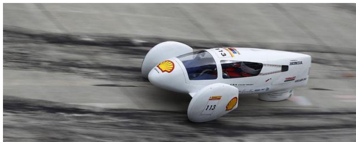
Figura 19 - Modelo de triciclo revertido usado pela maioria dos protótipos da Shell Eco-Marathon
