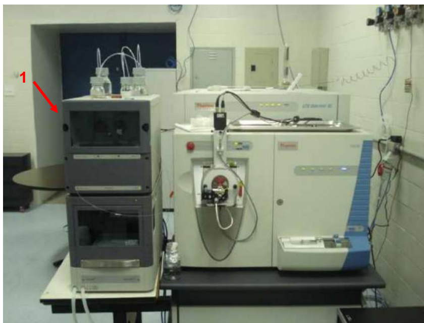
Figura 4: Espectrômetro de massa híbrido utilizado para efetuar experimentos em proteômica. 1) Nano HPLC; Na parte posterior e anterior encontram-se os analisadores Orbitrap XL e Linear Trap LTQ. As possibilidades de fragmentação ligadas aos analisadores são CID, ETD e HCD
