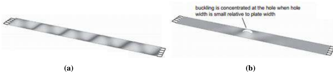
Figura 2.8. Comportamento de uma placa apoiada submetida a compressão (a) sem e (b) com perfurações (MOEN & SCHAFER, 2009).
