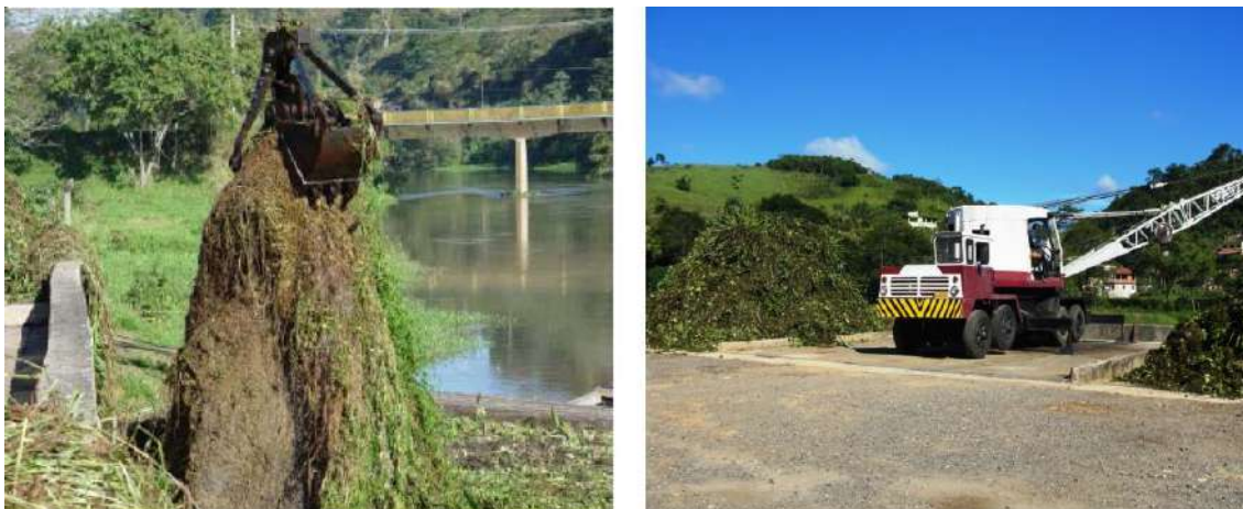
Figura 3.25 – Guindaste de apoio à barreira de contenção ( log-boom ) no reservatório de Santana.
