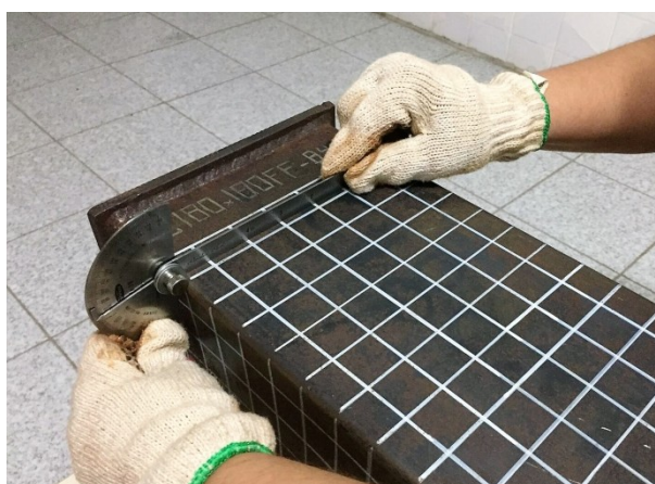
Figura 4.4 - Medição das seções transversais: (a) das dimensões, através da utilização de um paquímetro e (b) dos ângulos internos, com auxílio de um goniômetro.
