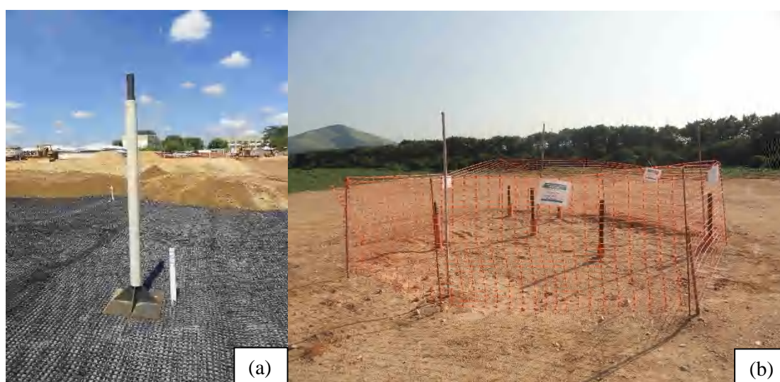
Figura 3.27 – (a) Placa de recalque e (b) cercado de proteção
