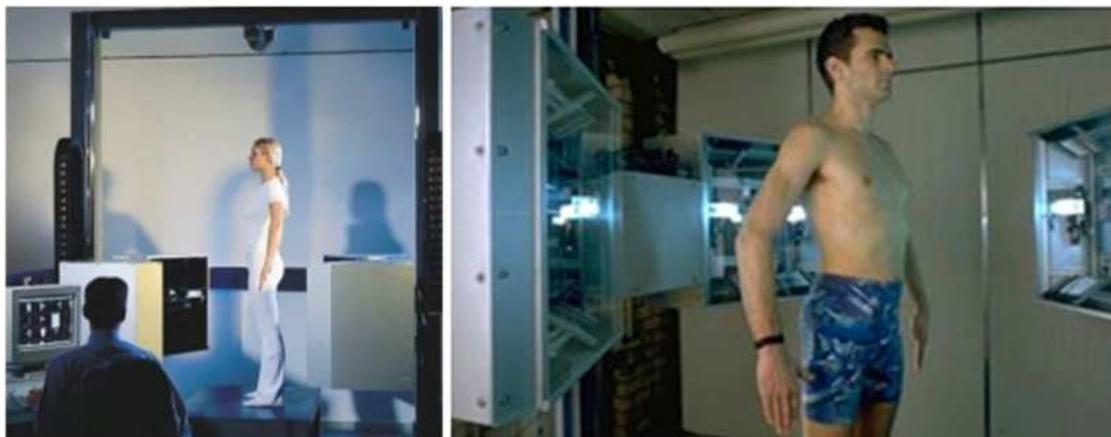
Figura 12: scanner a laser de corpo inteiro *Tecmath Vitronic Vitus Pro* e detalhe das cabeças a laser
