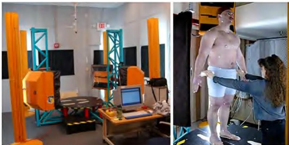
Figura 13: scanner a laser de corpo inteiro *WB4* (à esquerda). Posicionamento da pessoa no scanner *WB4*. Pesquisa *CAESAR* (ROBINETTE, 2005).
