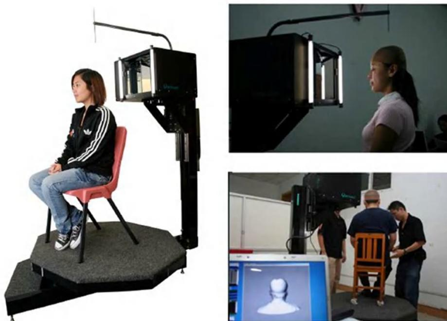
Figura 3: posicionamento da pessoa para realizar a digitalização na pesquisa *SizeChina*. *scanner* Cyberware 3030 (BALL, 2011)
