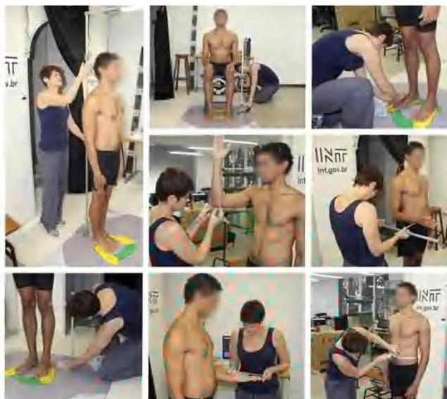
Figura 41: colocação de marcadores azuis e medição tradicional utilizando antropômetro, compasso de corrediça pequeno e fita métrica
