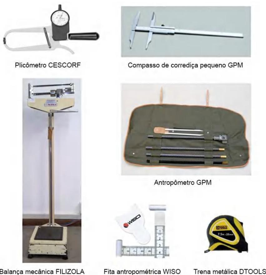
Figura 25: equipamentos tradicionais de medição utilizados na coleta das 46 medidas antropométricas 1D dos atletas de *Jiu-Jitsu*
