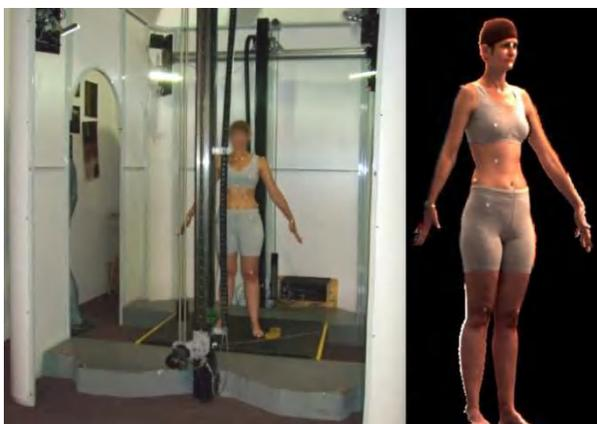
Figura 38: *scanner* 3D a laser de corpo - *Cyberware WBX* - e *scan* 3D gerado
