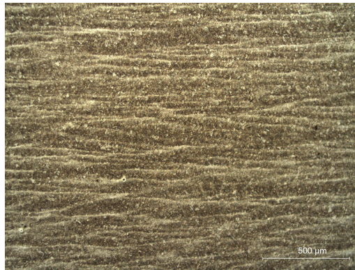
Figura 4.4: Bandas de segregação observadas em microscopia óptica na amostra somente temperada (T)
