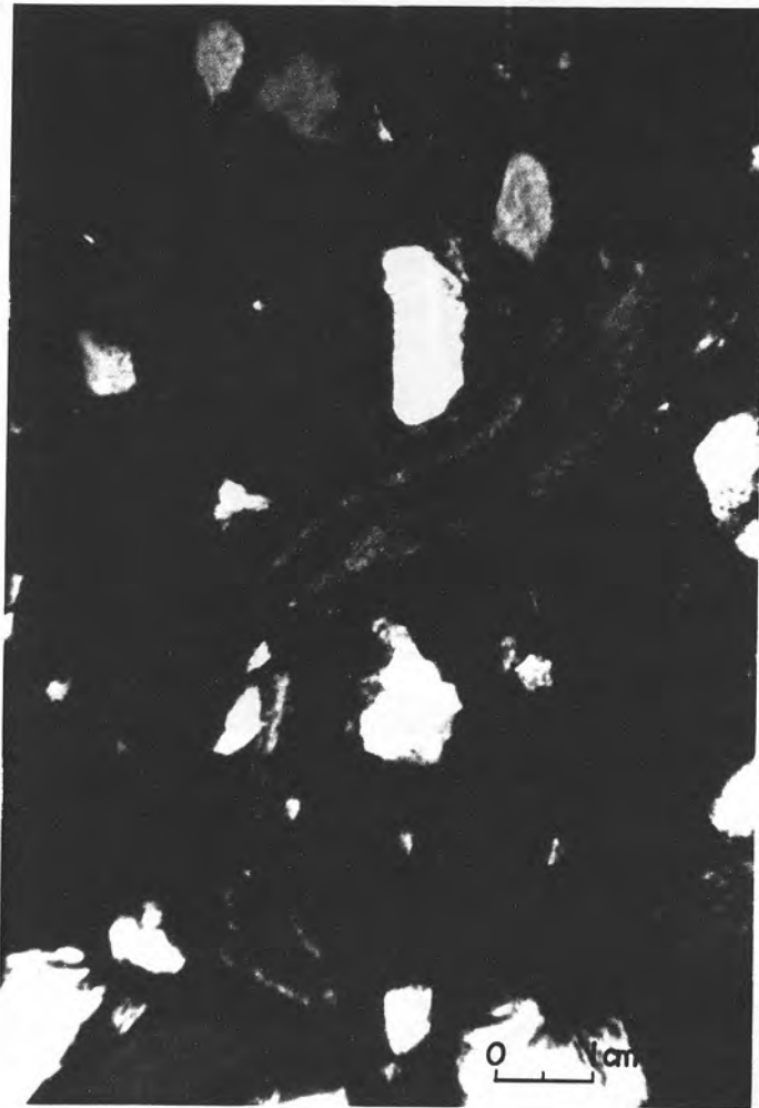
Fotomicrografia 20 - Mica deformada mecanicamente. Apresenta-se bastante alterada, o que é evidenciado pela baixa birrefringência (cloritizada?). Nicóis cruzados. (amostra FSJ-07: Aloformação Manso - fácies Quebra-Canto - litof. Fm)
