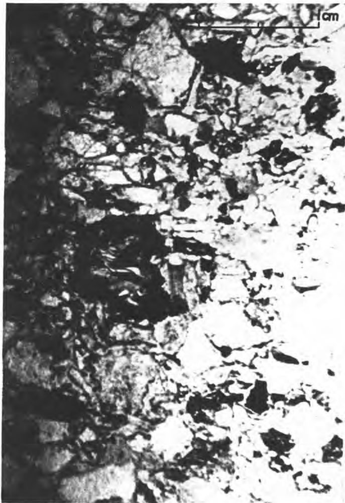
Fotomicrografia 01 - Material arenoso clasto-suportado, muito mal selecionado, grãos angulosos, com porosidade intergranular. Os minerais tabulares se apresentam orientados (estratificação horizontal pouco desenvolvida). Composição: biotita deformada, quartzo monocristalino, litoclasto argilosos amarelados, concreções granulares pretas e avermelhadas; sem estrutura visível. Litofácies Sh, na localidade Fazenda Leal. (amostra SFL-01: Aloformação Manso-fácies Campinho-litof. )
