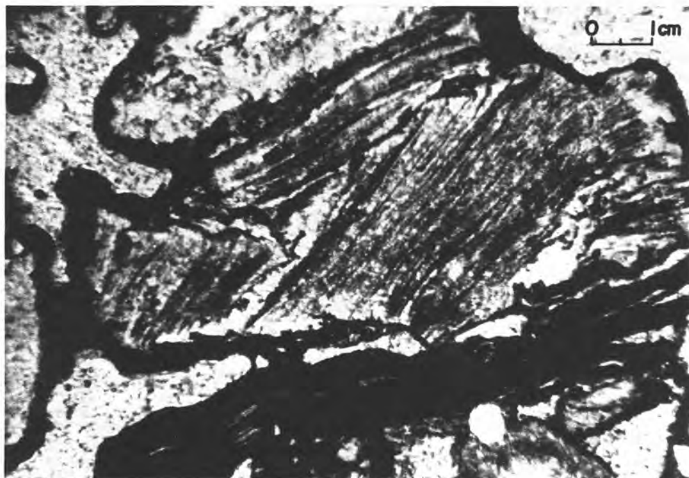
Fotomicrografia 24 - Micas (biotitas) deformada e alterada. Oxido/hidróxido de ferro preenchendo parcialmente a porosidade intergranular; a origem desta cimentação incipiente parece ser das biotitas que se apresentam incolores. (amostra FSJ-11: Aloformação Manso - fácies Campinho - litof. Fl/Fm))
