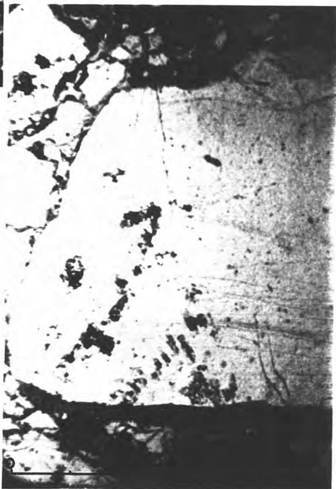
Fotomicrografia 07 - Grânulo de quartzo monocristalino com fina película de argila contornando-o: resultado do retrabalhamento de material coluvial. (amostra BV-3).
