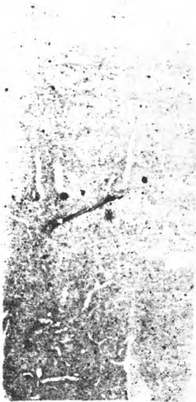
Figura 19 - Positivos fotográficos obtidos com raio-x de penetração em amostras indeformadas - seção Fazenda São Joaquim, amostras FSJ#2 e FSJ#7. Escala: 1:1.
