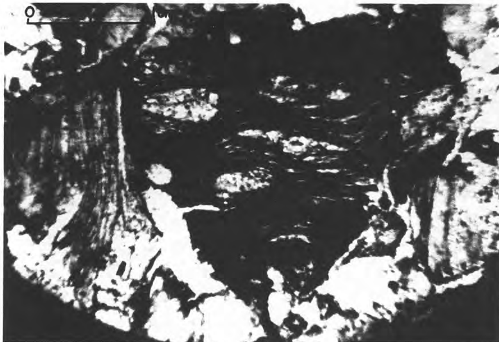
Fotomicrografia 22 - Biotita com preenchimento por Oxido/hidróxido de ferro nos planos de clivagem; suas lamelas encontram-se deformadas e bastante onduladas. (amostra SFL-01: Aloformação Manso - fácies Campinho - litof. Fl)
