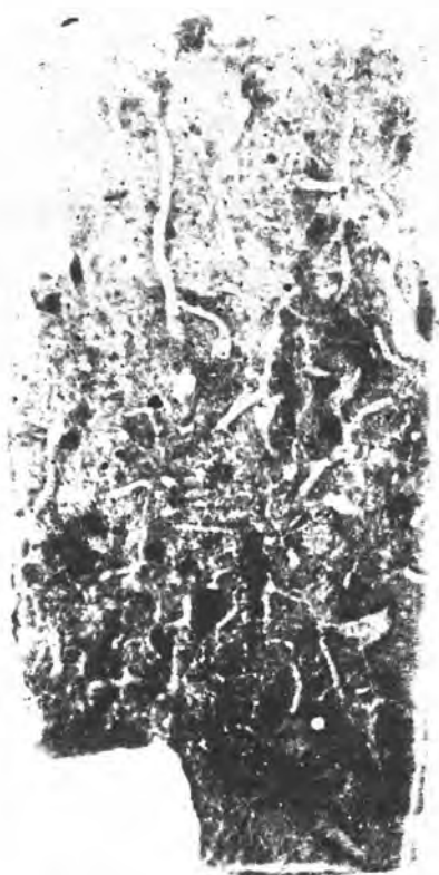
Figura 35 - Positivos fotográficos obtidos com raio-X de penetração em amostras indeformadas - seção Cotiara COTA#1, COTA#2, COTA#4 e COTB#1 (in Silva, 1991). Escala: 1:1.
