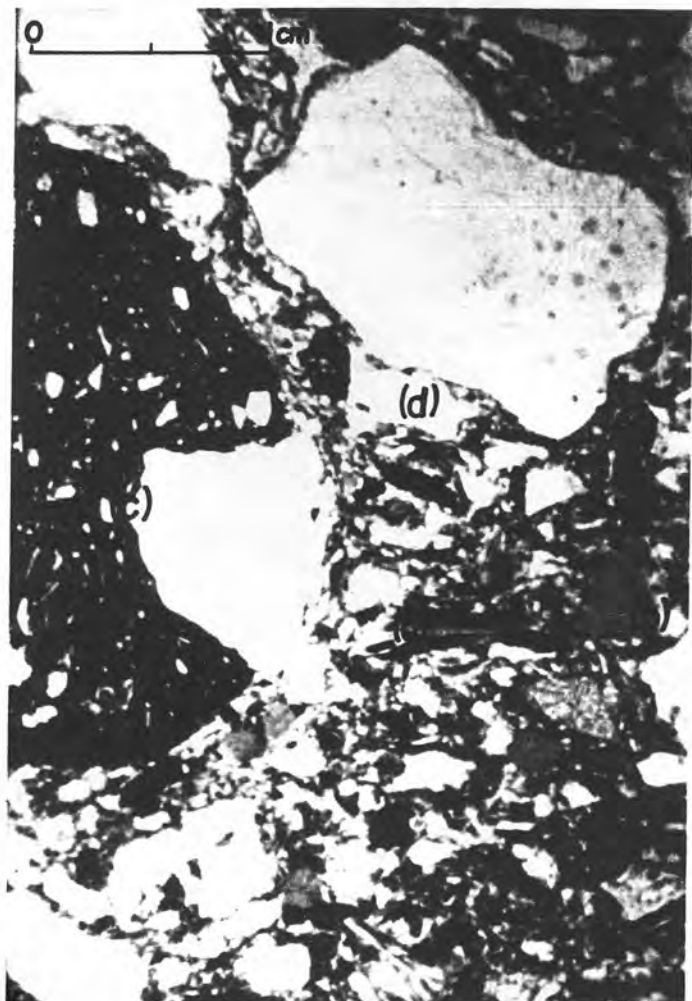
Fotomicrografia 07 - Grânulo de quartzo monocristalino com fina película de argila contornando-o: resultado do retrabalhamento de material coluvial. (amostra BV-3).
