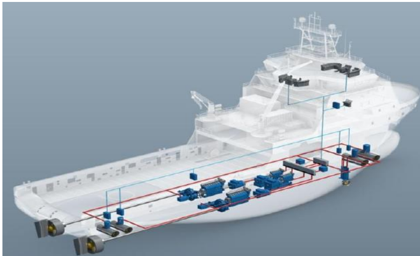
Figura 9: Sistema Propulsivo Híbrido (Fonte: Wartsila)
