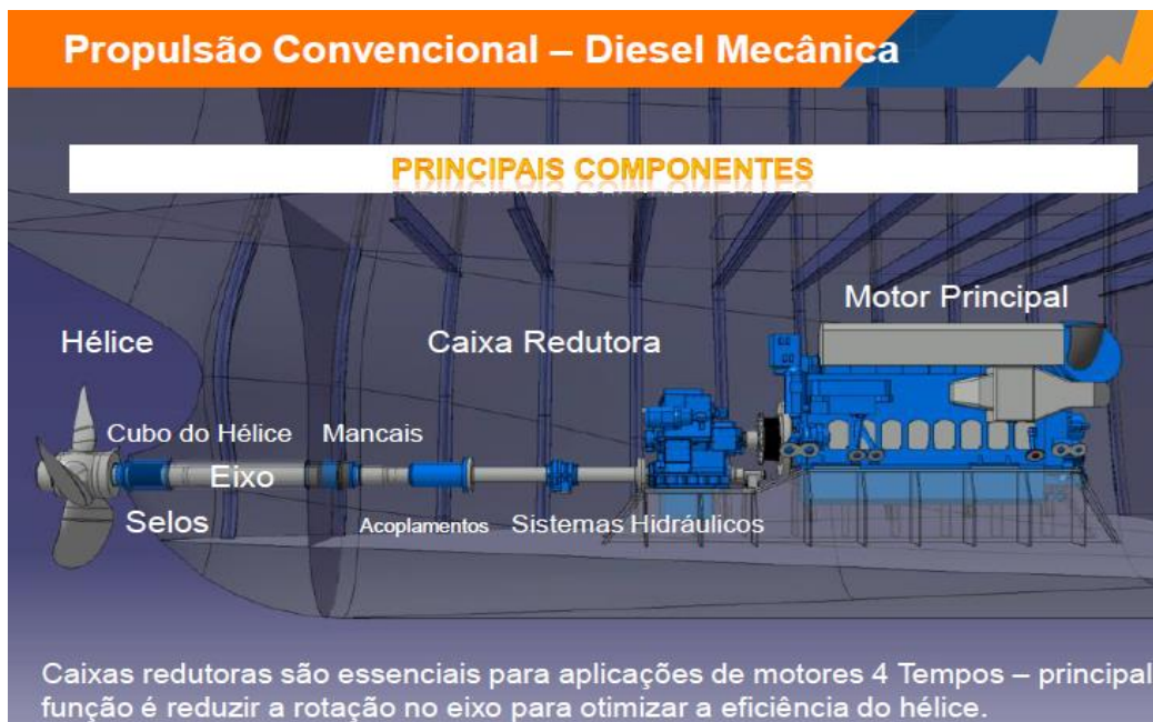
Figura 3: Propulsão Diesel Mecânica (Fonte: Wartsila)
