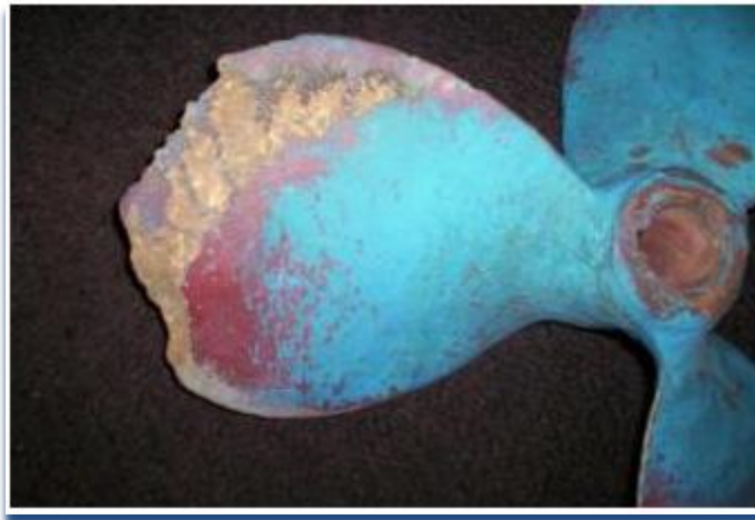
Figura 18: Cavitação em Propulsores
