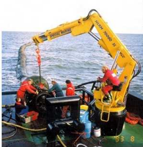
Figura 10: Exemplo de guindaste de serviço para a operação dos equipamentos dos ROV's
