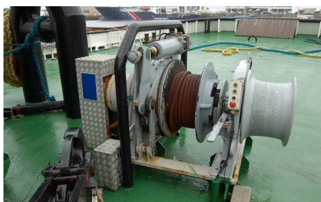
Figura 7: Exemplo de guincho utilizado na movimentação de cabos
