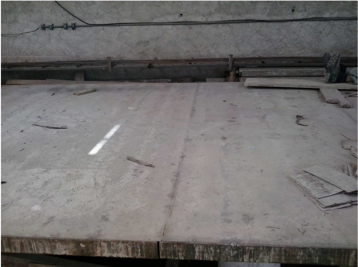
Figura 3-15 Pistas utilizadas como forma na produção dos pré-fabricados (Autor 2013)
