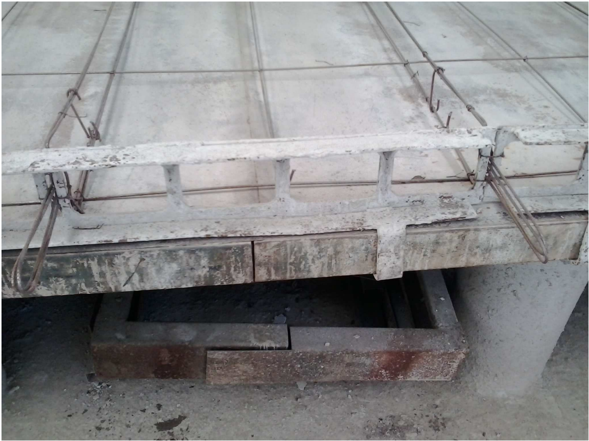
Figura 3-3 Guias utilizadas como forma na produção dos pré-moldados (Autor 2013)
