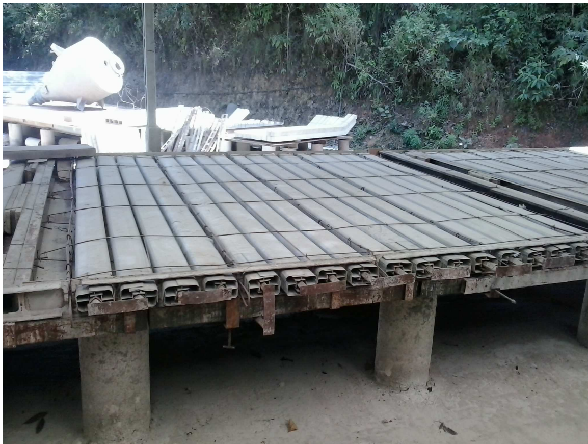
Figura 3-18 Hastes metálicas utilizadas na expansão dos alvéolos Autor
