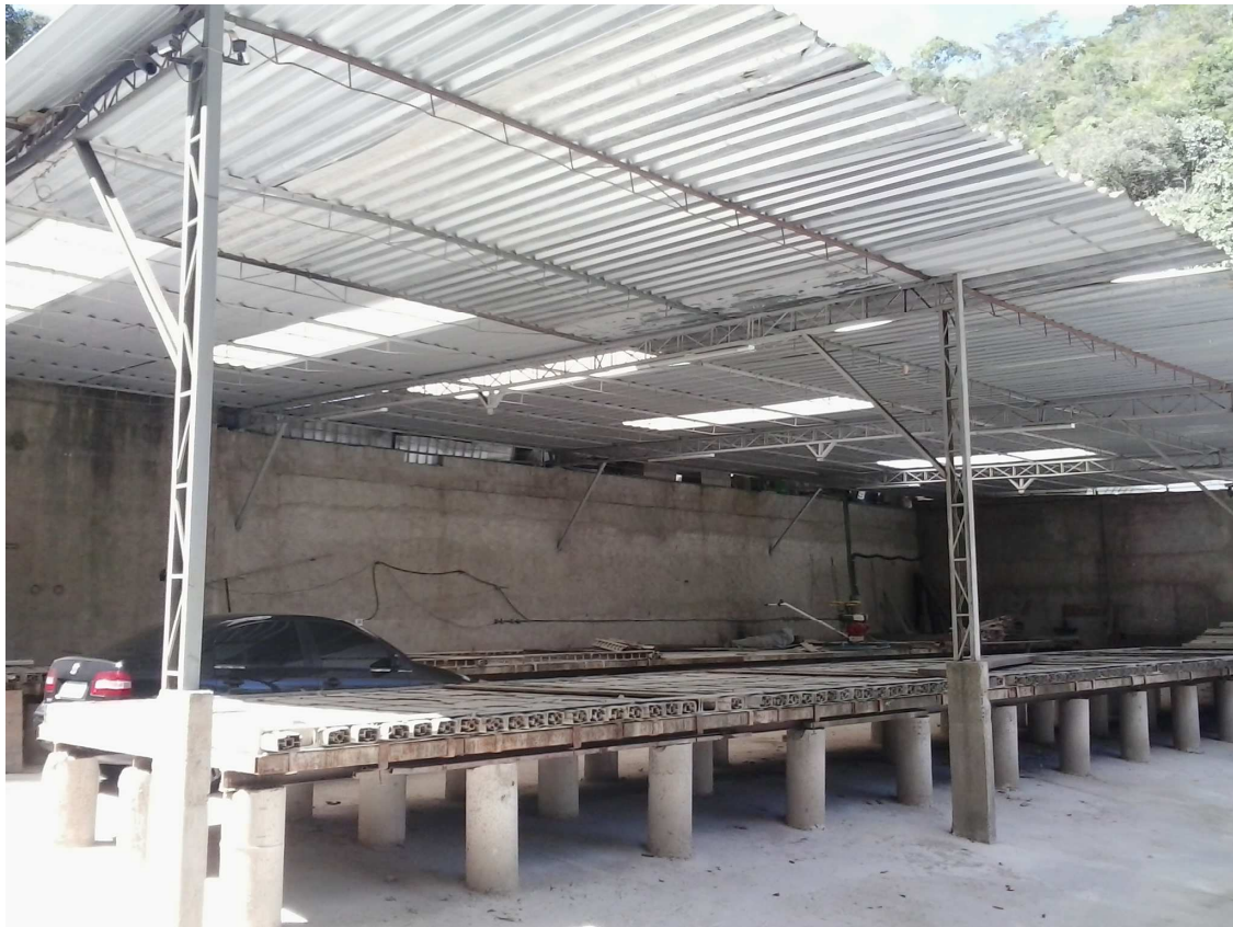
Figura 3-6 Pistas utilizadas como forma na produção dos pré-moldados (Autor 2012)
