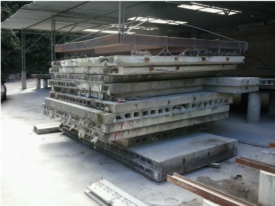
Figura 3-23 Painéis pré-fabricados descartados devido a ocorrência de patologias (Autor 2013)
