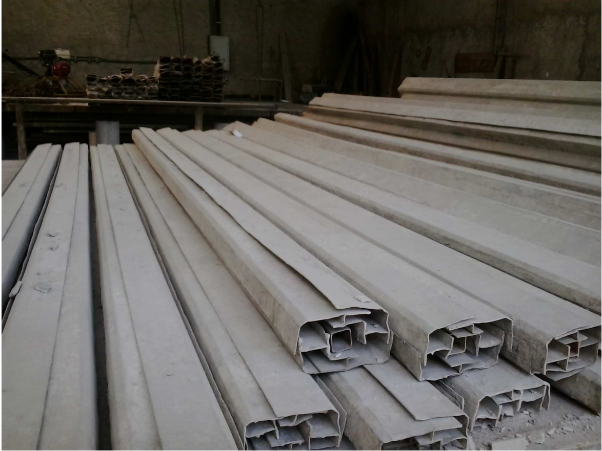
Figura 3-4 Alvéolos utilizados em conjunto com as forma na produção dos pré-moldados (Autor 2013)
