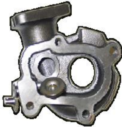
Figura 2.3.3.1 – carcaça quente do turbocompressor (Garret)
