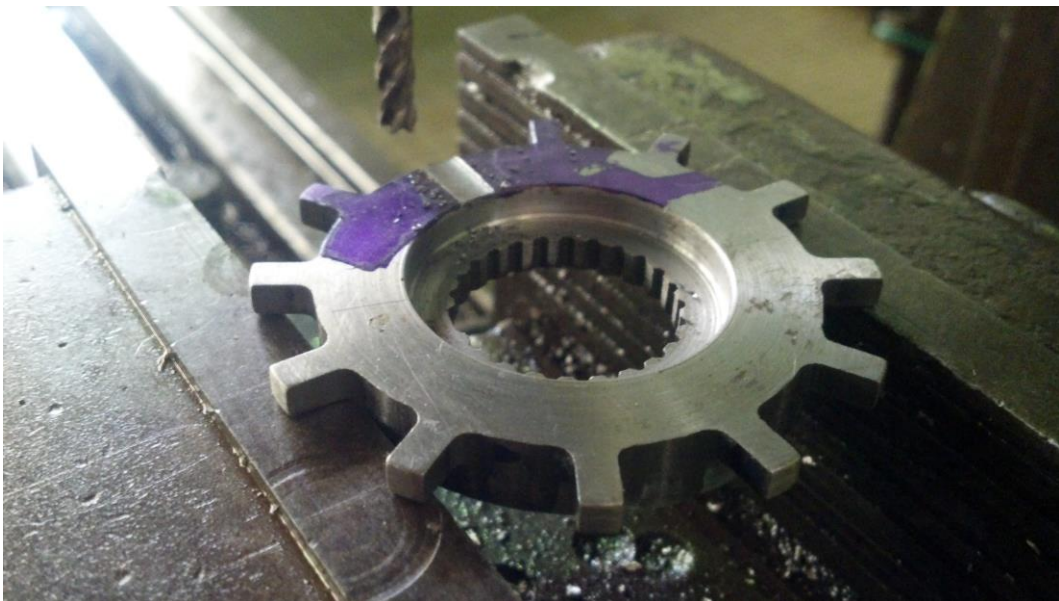
Figura 4.3.3 – Fabricando o rasgo na RF
