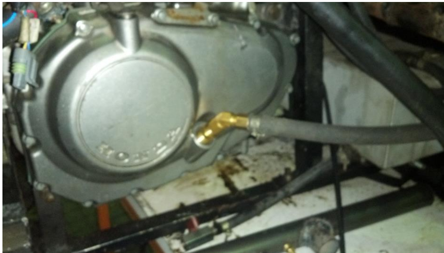
Figura 4.6.3-Retorno de óleo para o motor
