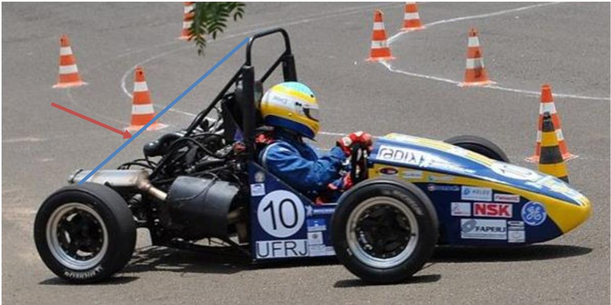
**Figura 7 - Protótipo do Formula SAE. Detalhe para as restrições geométricas impostas ao posicionamento do sistema de admissão**
