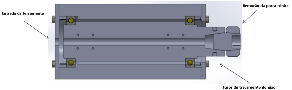
Figura 10.7.2 – Esquema de montagem do cone morse.
