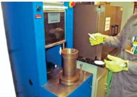
(c) Colocação do papel-filtro no fundo do molde
