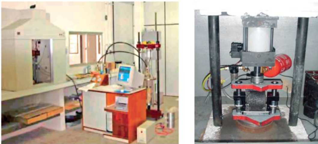
Figura 2.21: Exemplos de equipamento para ensaio de compressão diametral de carga repetida (BERNUCCI et al, 2008)
