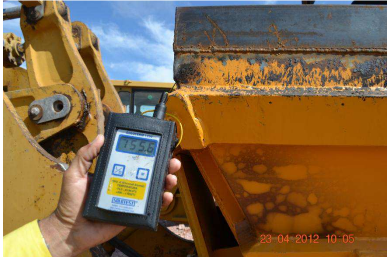
Figura 3.25: Controle de temperatura do concreto asfáltico - UHE Jirau (RAMALHO et al., 2013)
