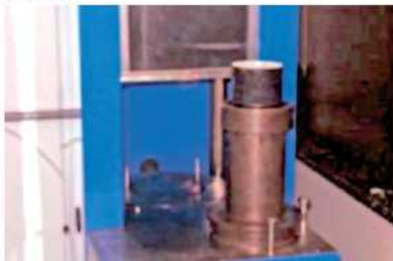
(g) Extração do corpo-de-prova após compactação
