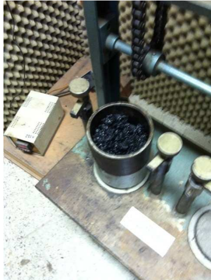
Figura 4.12: Colocação da mistura dentro do molde metálico.
