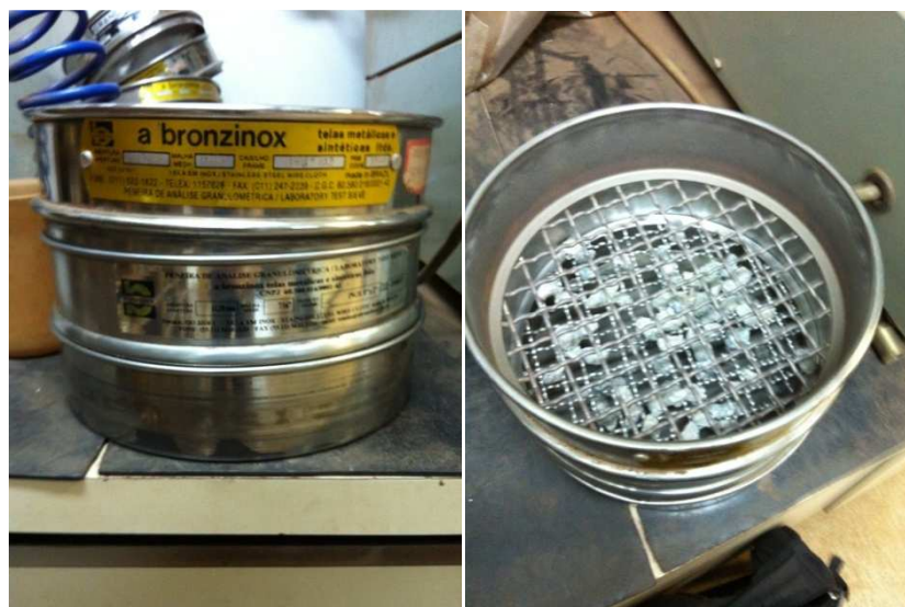
Figura 4.2: Peneiras circulares utilizadas para peneirar a porção de 11,2 mm
