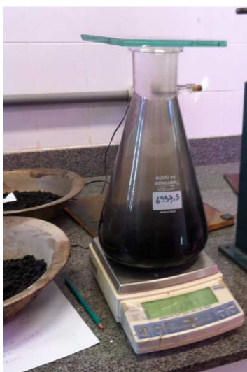
Figura 4.19: Pesagem do recipiente cheio com água.
