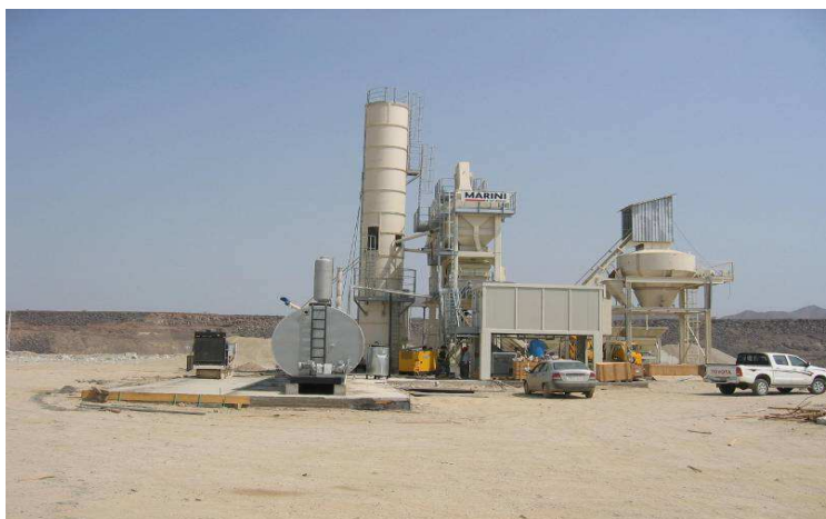
Figura 2.15: Planta típica de produção de concreto asfáltico (HÖEG, 2009)
