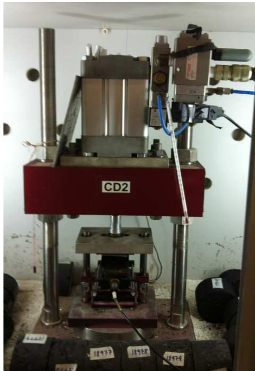
Figura 4.28: Prensa de compressão diametral para módulo de resiliência (MR) da COPPE usada neste trabalho.
