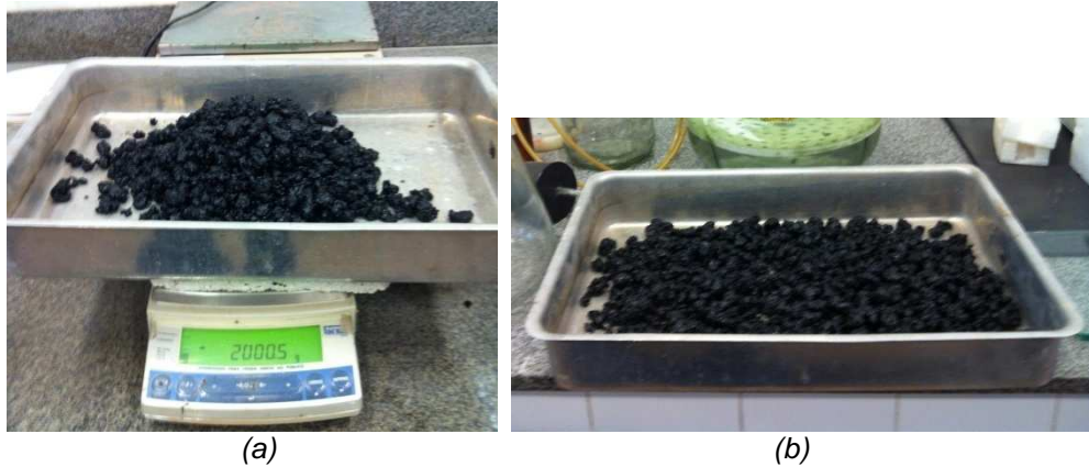
Figura 4.17: a) Pesagem da amostra; b) Separação dos grumos para p ensaio Rice.
