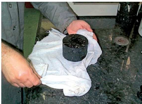
(a) Após retirada da imersão em água
