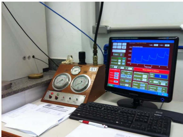
Figura 4.29: Sistema de aquisição de dados da prensa da COPPE usada neste trabalho.
