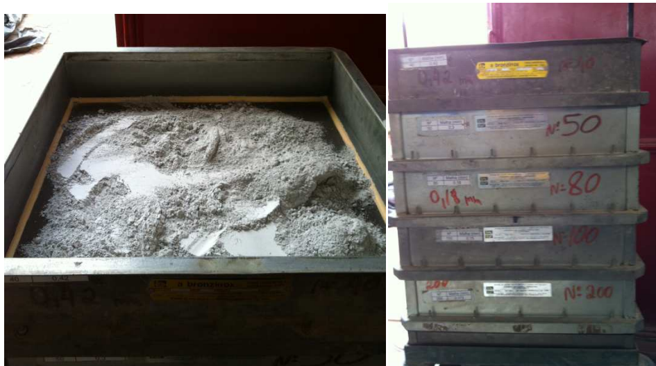
Figura 4.3: Calcário usado para compor o filer e arranjo de peneiras
