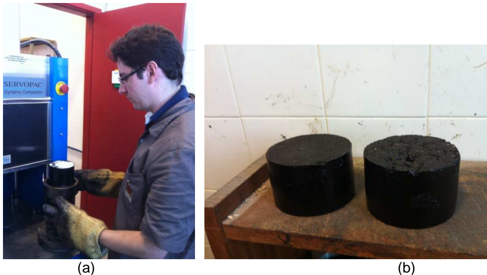
Figura 4.24: a) Retirada do corpo de prova do molde; b) Corpos de prova resfriando à temperatura ambiente.
