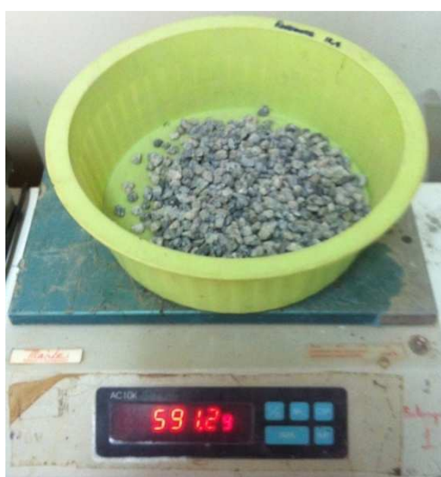
Figura 4.4: Pesagem do material peneirado para compor um corpo de prova da mistura asfáltica.
