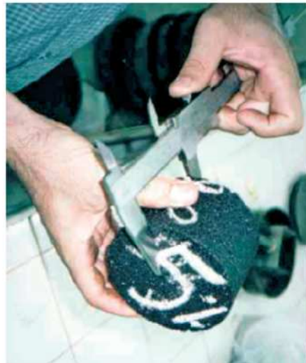
(f) Medidas das dimensões do corpo-de-prova
