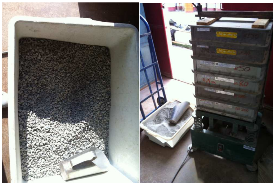
Figura 4.1: Material a ser peneirado e montagem das peneiras.
