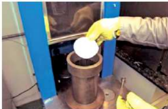
(e) Colocação do papel-filtro no topo do molde após a mistura
