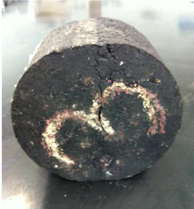
Figura 4.27: Corpo de prova após a execução do ensaio de resistência à tração (RT).
