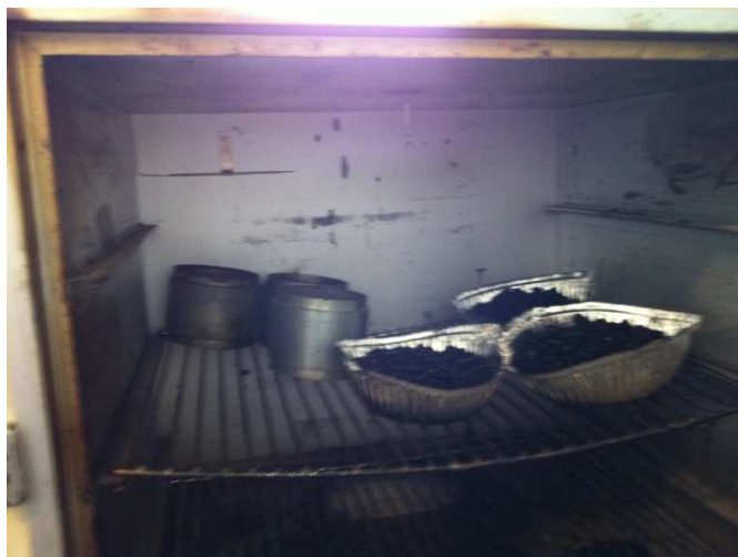
Figura 4.14: Amostras e moldes metálicos em espera em temperatura controlada na estufa.
