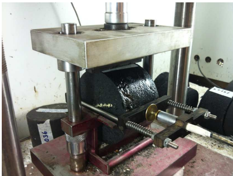
Figura 4.30: Detalhe do friso metálico e do LVDT do ensaio de MR deste trabalho.
