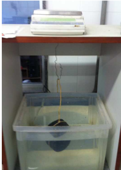
Figura 4.16: Determinação da massa submersa para cálculo da Gmb .
