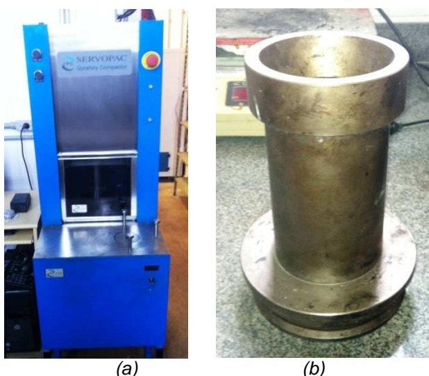
Figura 4.20: a) Compactador Giratório Superpave (CGS); b) Molde metálico de 10 cm de diâmetro.
