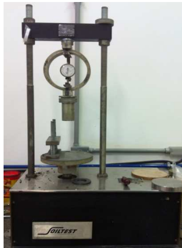
Figura 4.25: Prensa Marshall de Resistência à Tração.
