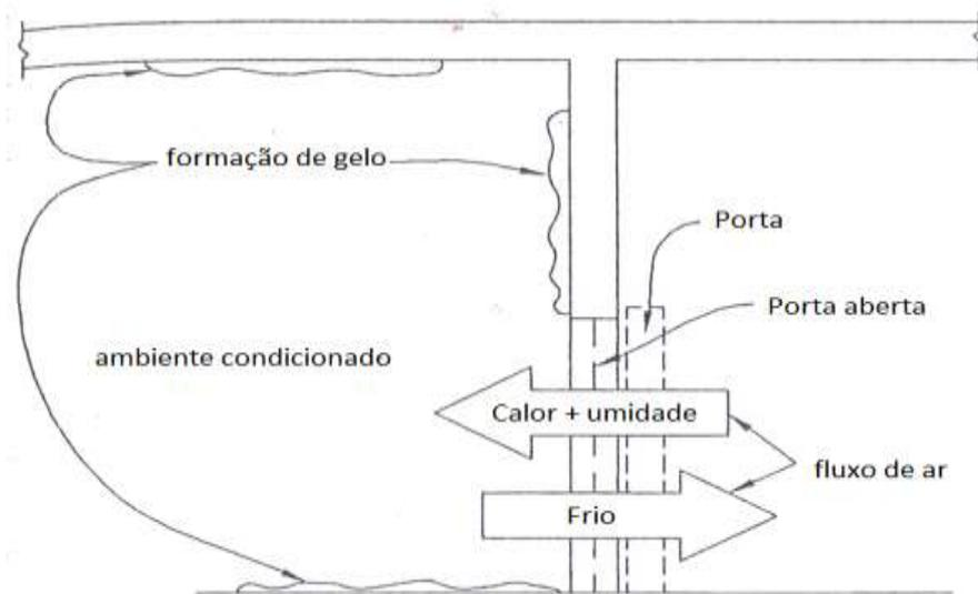
*Figura 1.5. Infiltração de calor e umidade (Adaptado de [3])*
