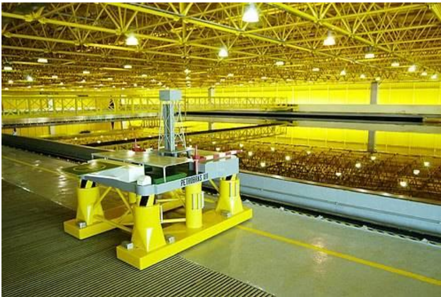
Figura 5 – Modelo de uma plataforma de petróleo em escala reduzida Fonte: LabOceano.
