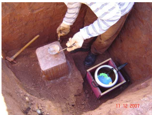
Figura 3.1 - Retirada de bloco indeformado no campo experimental de Adrianópolis.
