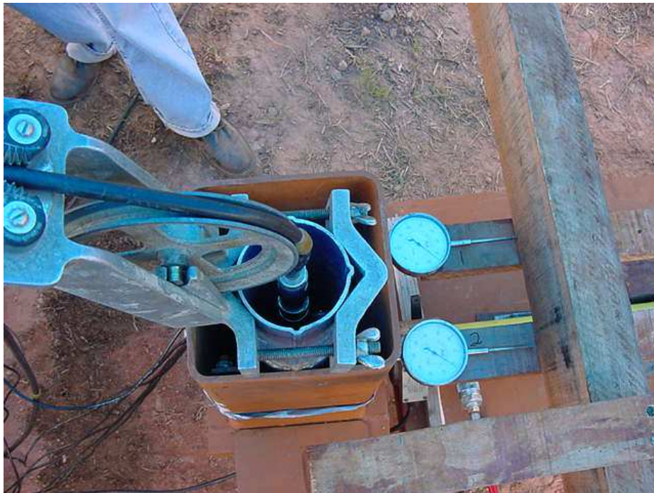
Figura 3.20 – Vista do torpedo de inclinômetro no interior do tubo na estaca 1. (GUIMARÃES, 2007).
