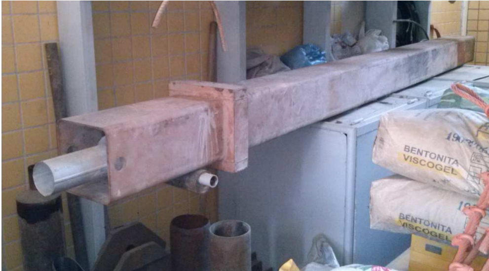
Figura 3.13 – Estaca 2, retirada do solo, após prova de carga.
