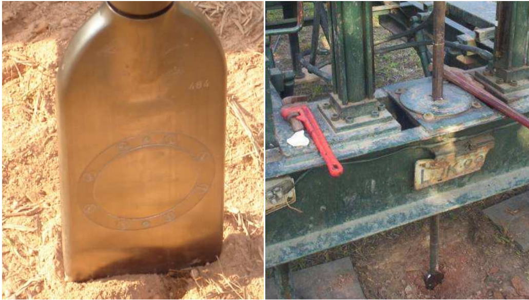
Figura 3.6 - Detalhe da lâmina do DMT sendo inserida no solo e realização do ensaio.
