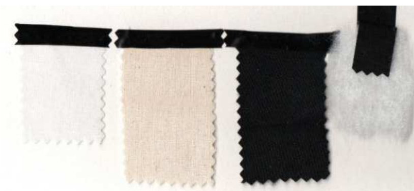
Figura 21: Materiais #1: (1) Entre tela, (2) algodão cru, (3) gabardine e (4) enchimento acrílico, (2024). Acervo pessoal
