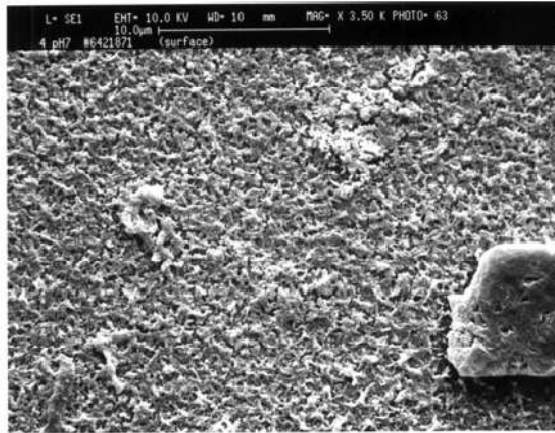
Figura 15 - Microscopia eletrônica de varredura da superfície da membrana com incrustação por matéria orgânica.
