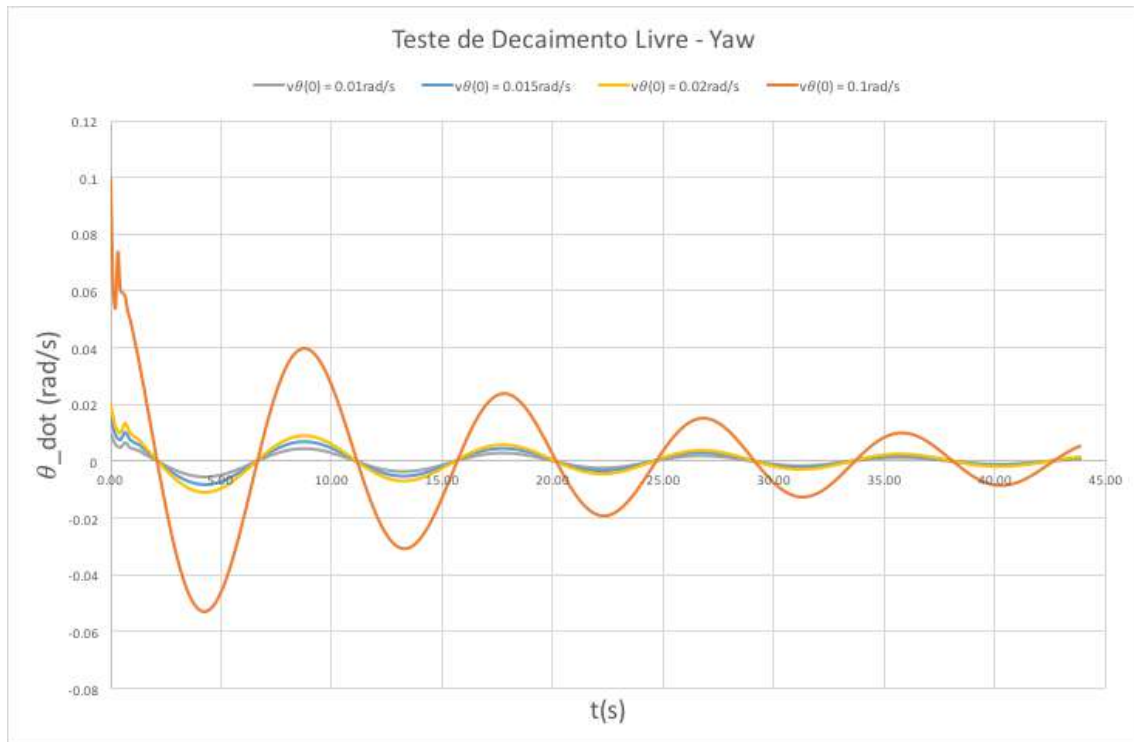
Figura 6.10 – Séries Temporais de Velocidade - Teste de Decaimento em Yaw
