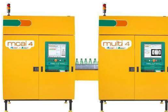
Figura 24: Inspetores eletrônicos da área fria.
