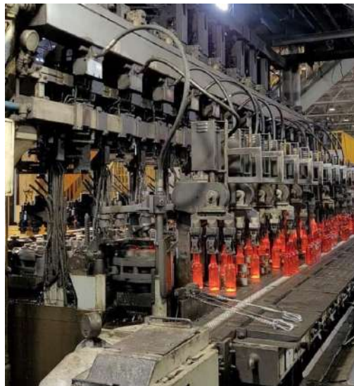
Figura 18: Máquina IS utilizada na produção de garrafas de vidro.
