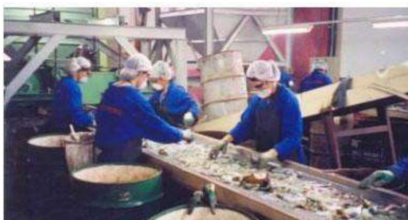
Figura 27: Catação manual em processo semiautomatizado de beneficiamento de caco
