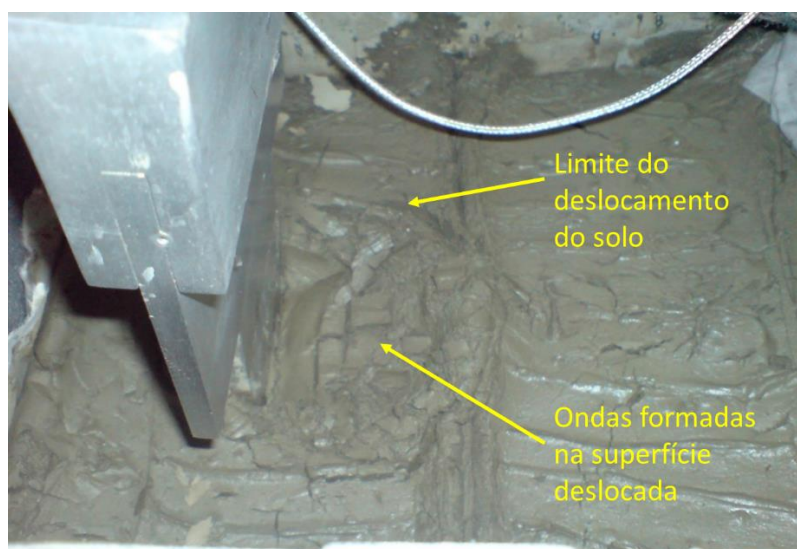
Figura 5-58 - Foto do ensaio na centrífuga com o Duto 3D após o deslocamento da pá
