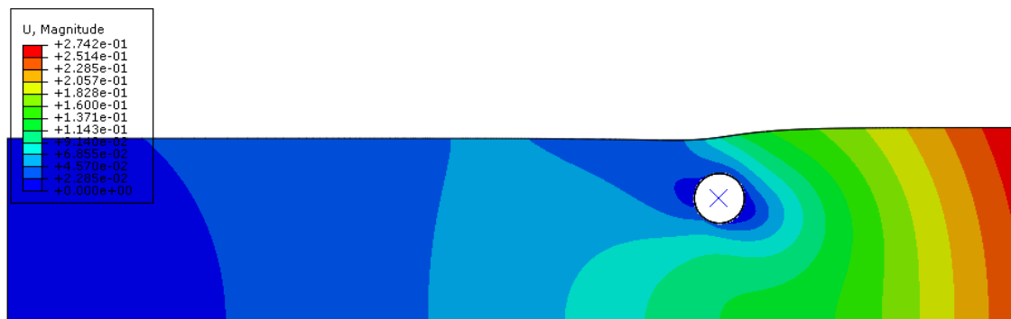
Figura 5-7 - Deslocamento total para Duto 3D com 167% de enterramento – Solo Cam-clay – Modo implícito
