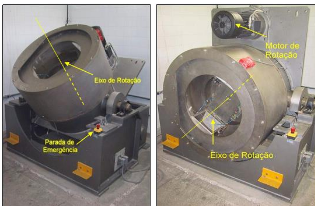
Figura 2-2 - Centrífuga de tambor da COPPE (OLIVEIRA, 2005)
