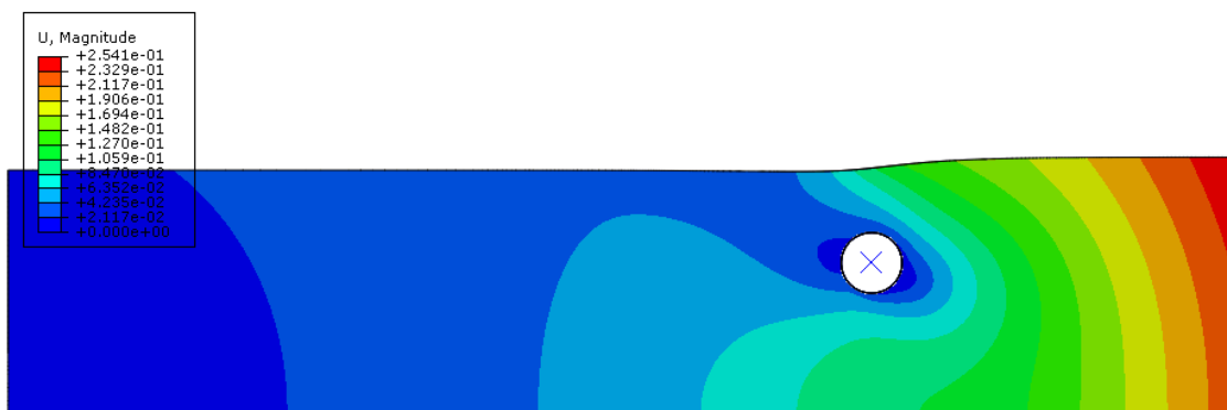
Figura 5-3 Deslocamento total para Duto 3D com 200% de enterramento – Solo Cam-clay – Modo implícito
