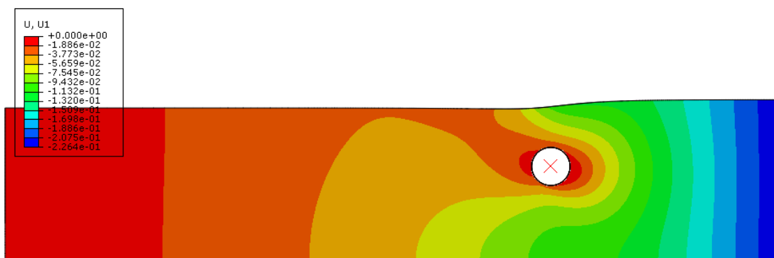
Figura 5-1 - Deslocamento horizontal para Duto 3D com 200% de enterramento – Solo Cam-clay – Modo implícito
