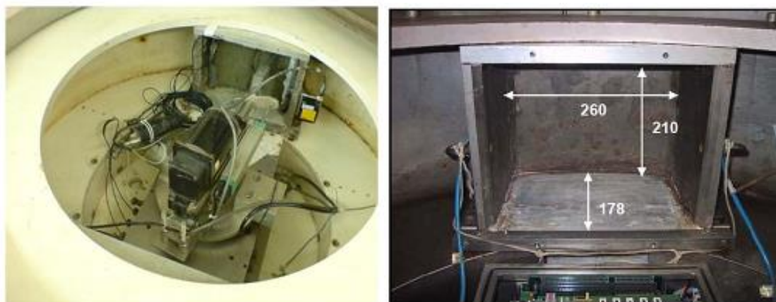
Figura 2-3 - Canal de amostra da centrífuga e detalhe da caixa de amostra do canal com dimensões em mm (PEQUENO, 2013)
