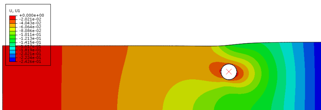
Figura 5-9 - Deslocamento horizontal para Duto 2D com 211% de enterramento – Solo Cam-clay – Modo implícito
