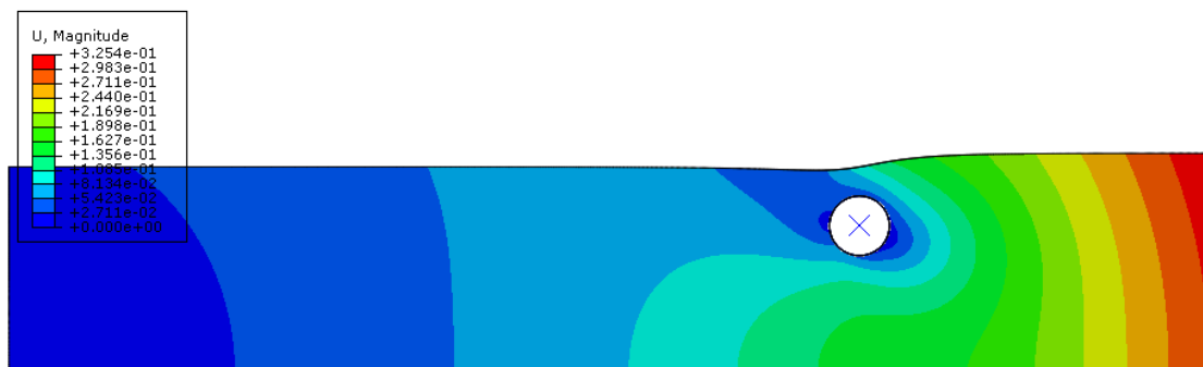
Figura 5-15 - Deslocamento total para Duto 2D com 144% de enterramento – Solo Cam-clay – Modo implícito
