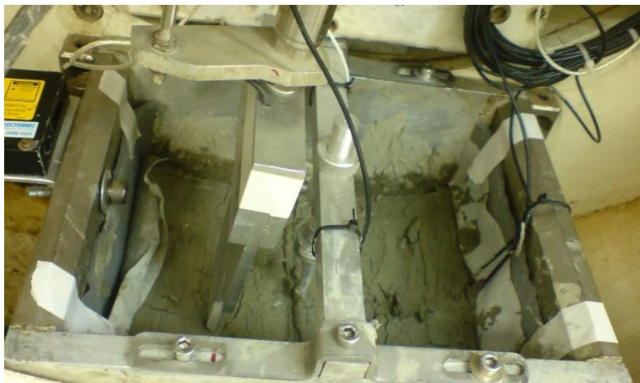
Figura 3-6 - Modelo 2D durante ensaio centrífugo, após inserção da pá. (PEQUENO, 2013)
