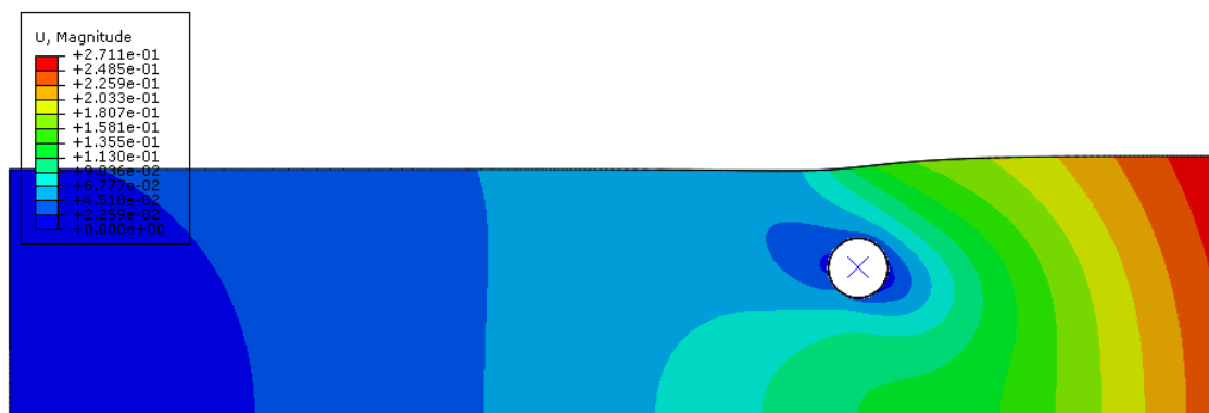
Figura 5-11 - Deslocamento total para Duto 2D com 211% de enterramento – Solo Cam-clay – Modo implícito
